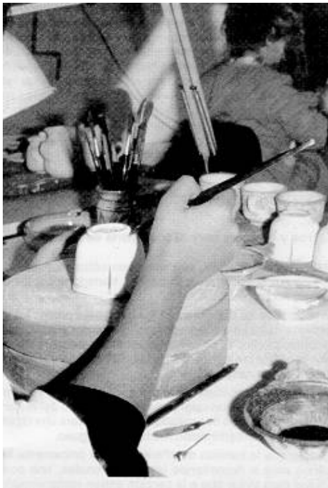
Fig. 4: Aplicación de pintura a pincel sobre la capa de barniz
